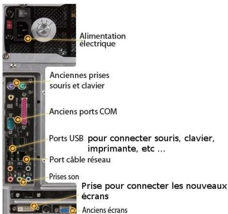
Image des prises situées à l'arrière de l'ordinateur
